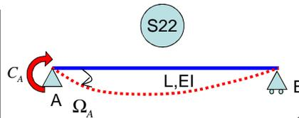
Moment dans la poutre iso :  $M_{22}(x) = C_A \left(1 - \frac{x}{L}\right)$
