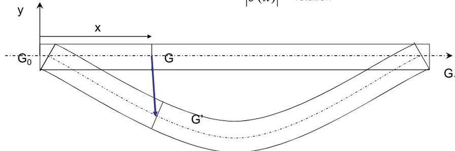
On suppose également que le point  $G_0$  subit des déplacements  $u_0, v_0$  et  $\theta_0$  supposés connus.
